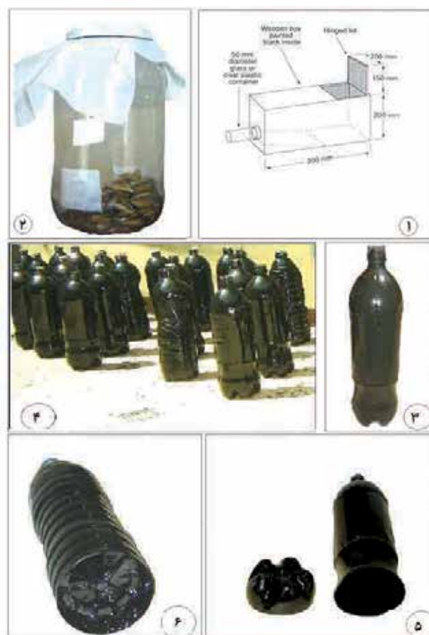
شکل ۳- ۱. جعبه تاریک جمع‌آوری حشرات (Upton & Chapman, 2010)، ۲. روش رایج فعلی در جمع‌آوری، ۳. رنگ مشکی بطری ۱/۵ لیتری، ۴. رنگ آمیزی بطری‌ها در فضای باز، ۵. برش انتهای بطری، ۶. بستن انتهای بطری با مقطع بریده شده
