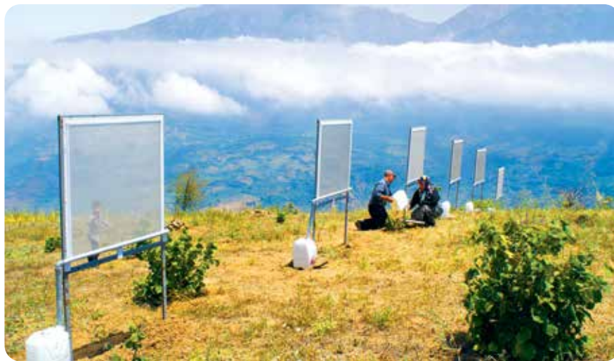
شکل ۳- نمایی از استقرار سامانه‌های جمع‌کننده پرده‌ای آب از مه و اندازه‌گیری آب جمع‌آوری شده در مخازن
