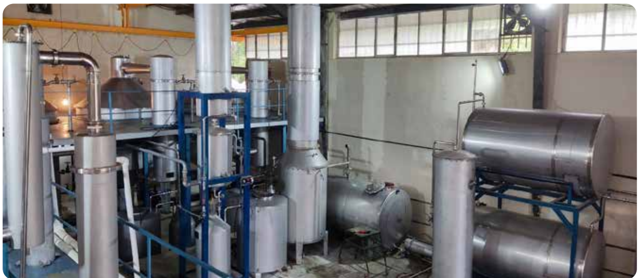
شکل ۳- نمایی از پایلوت نیمه صنعتی فراوری و دستگاه اسانس گیری گل محمدی در مؤسسه تحقیقات جنگلها و مراتع کشور
