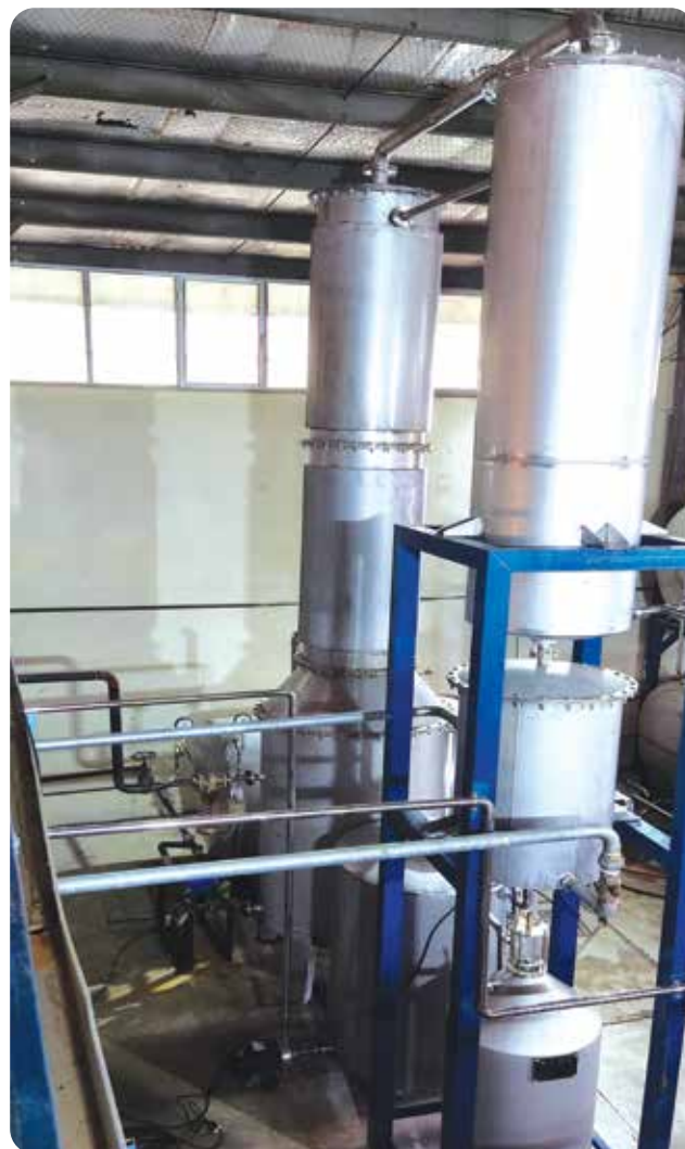
شکل ۵- نمایی از دستگاه کوه‌بیش (Cohobation) برای استخراج اسانس دوم گل محمدی
