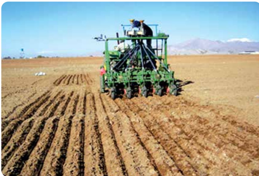
شکل ۵- دستگاه ردیف‌کار دانه‌ریز برای کشت مخلوط مکانیزه در ردیف‌های جداگانه Inter-Cropping در ایستگاه همد آسرد
