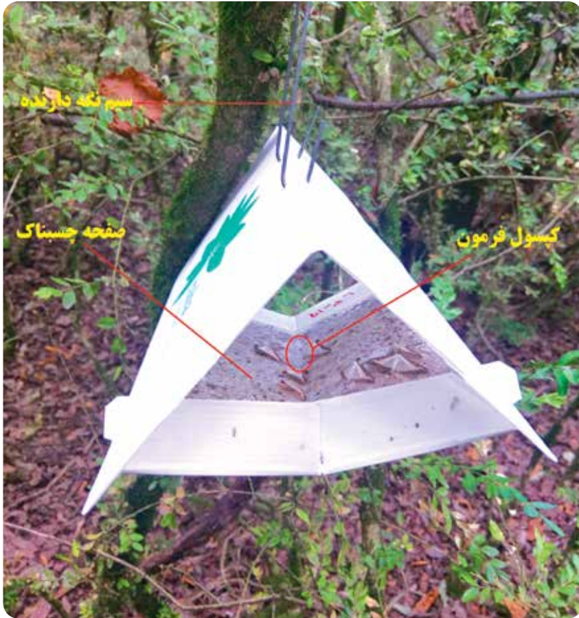
شکل ۳- نمای کلی و اجزای مختلف تله فرمونی دلتا
