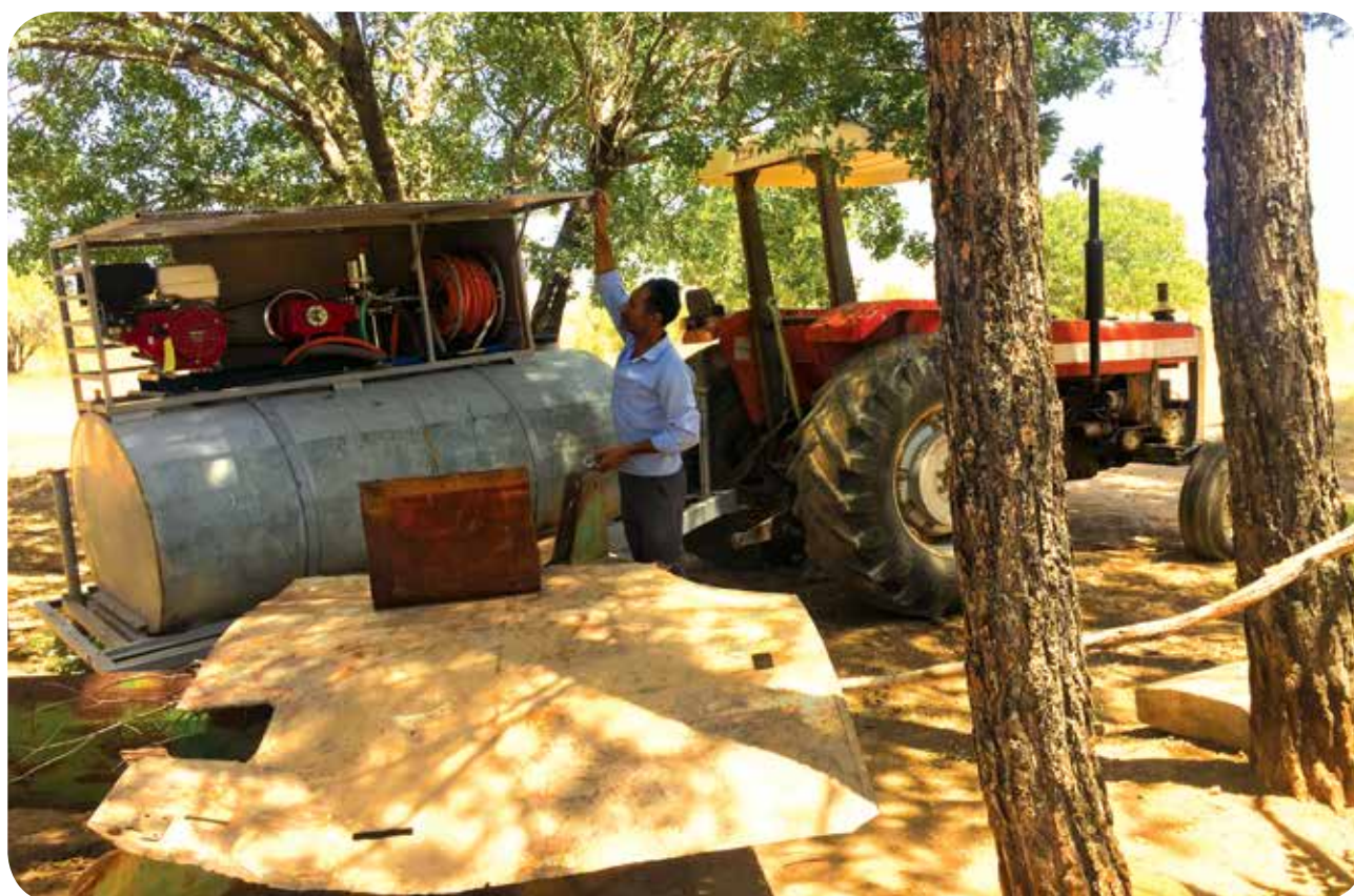
شکل ۹- ساخت تانکر ۲۰۰۰ لیتری و شلنگ‌های آب متصل به آن برای اطفای حریق احتمالی که به دلیل نبود لاستیک تراکتور یا تانکر در مواقع ضروری غیرقابل استفاده خواهد بود (عکس از: پوراسماعیل)
