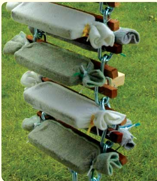
شکل ۱۳- پوشش‌دهی نمونه‌آزمایشی با ژئوتکستایل (Müller, 2018)
