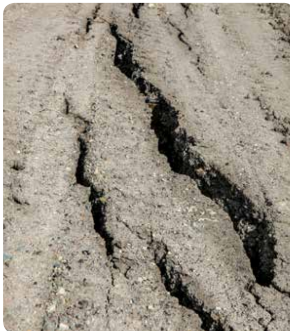
شکل ۱- فرسایش پذیری خاک و اگرآ و امکان ایجاد خسارت به تأسیسات (برگرفته از اینترنت)
