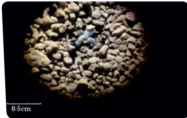
شکل ۷- تصویر تهیه شده از رسوبات مورد مطالعه توسط بینوکولار (تفاوت در اندازه دانه‌ها در تصویر به خوبی مشهود است).
