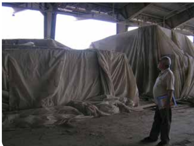
شکل ۵- ضد عفونی چوب‌های وارداتی با استفاده از روش‌های تدخینی (متیل بروماید) (عکس‌ها از: محمدابراهیم فراشپانی)
