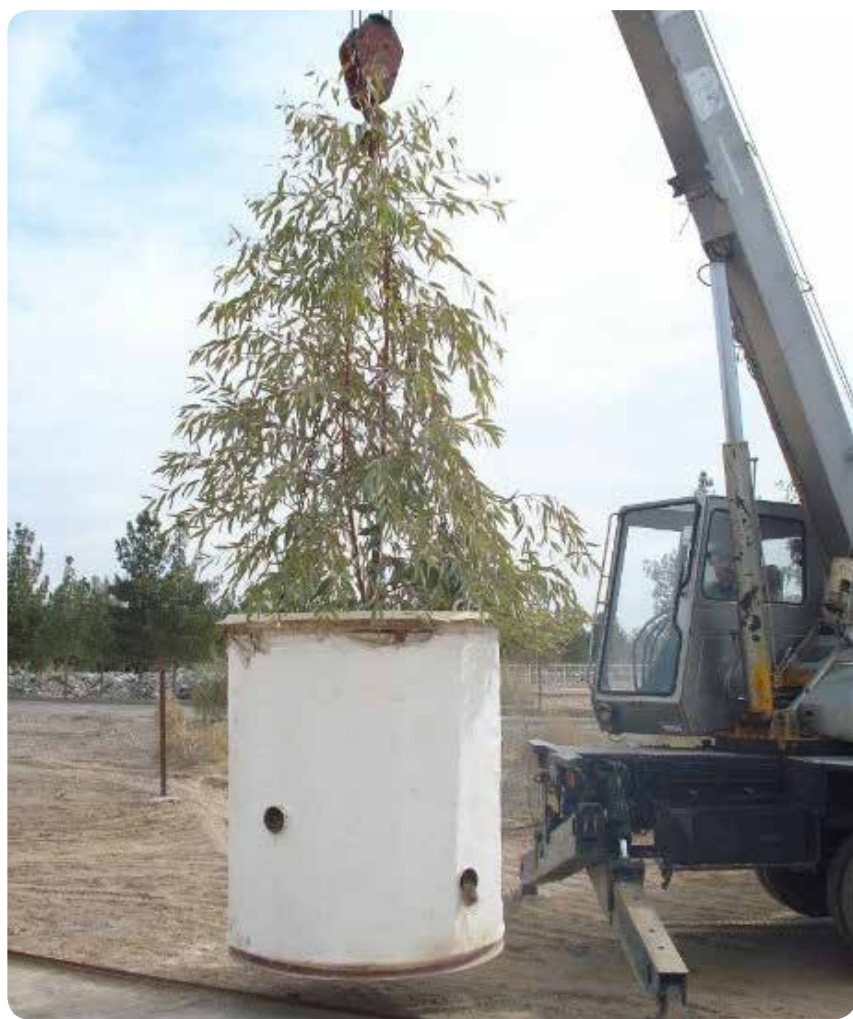
شکل ۴- نمایی از لایسمتر وزنی زهکش‌دار سایت تحقیقاتی آزمایش‌های لایسمتری ایستگاه تحقیقات بیابان‌زدایی شهید صدوقی یزد
