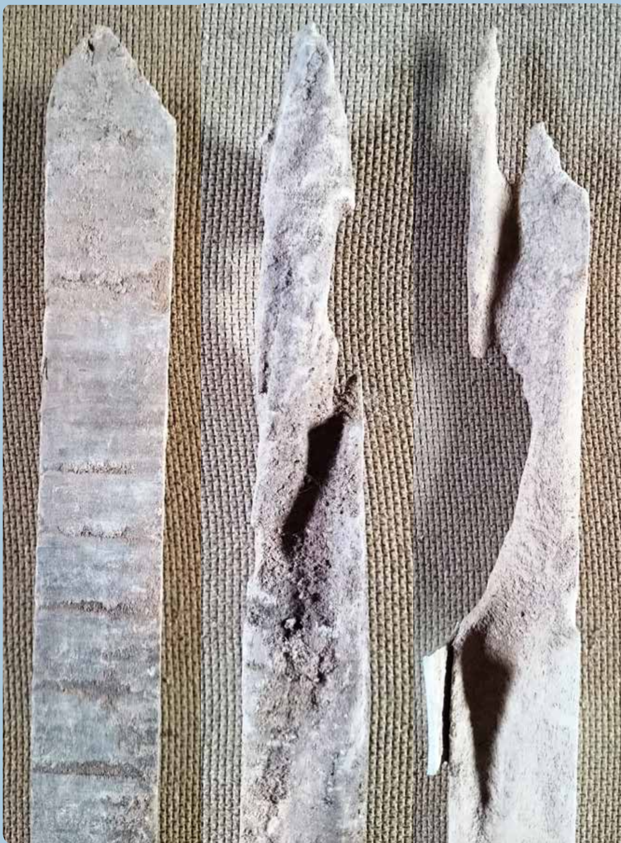
شکل ۲- تخریب چوب‌های شاهد (راست و وسط) و جلوگیری از تخریب چوب اشباع‌شده با کرئوزوت (چپ) توسط موریانه
