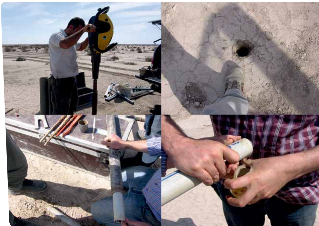
شکل ۶- مغزه‌گیری از رسوبات جازموریان و آماده‌سازی آنها جهت انتقال به آزمایشگاه
