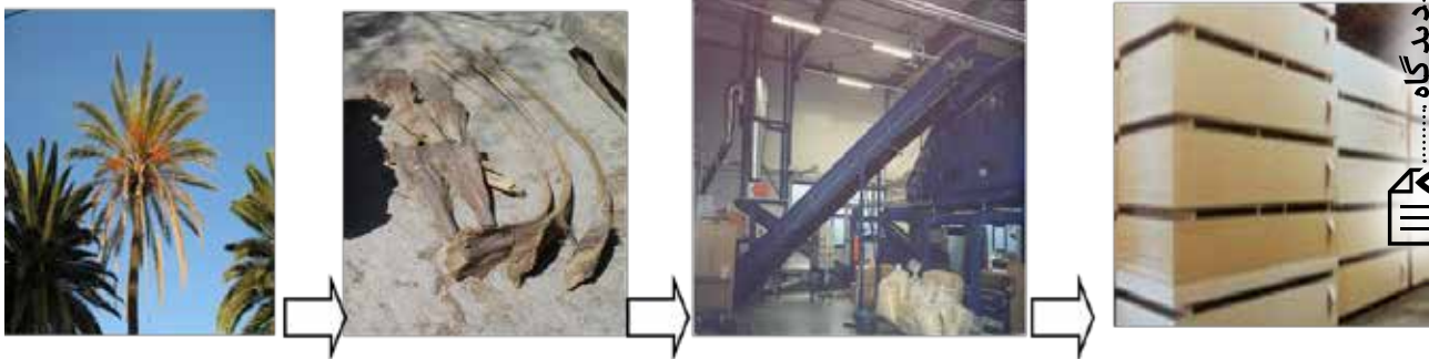
شکل ۸- نمایی از مراحل تولید MDF از ضایعات هرس نخل (از چپ به راست: نخل هرس نشده، ضایعات هرس، ماشین آلات تولید و تخته MDF)
