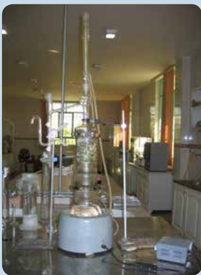
شکل ۱۲- اسانس‌گیری از سرشاخه گل‌دار مریم‌گلی با روش تقطیر با بخار آب
