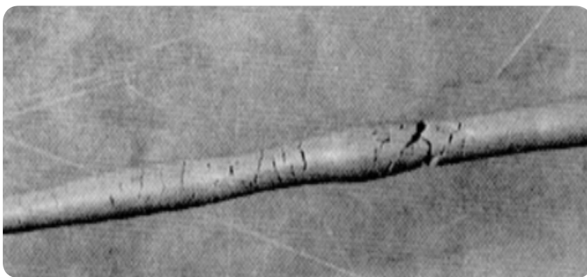
شکل ۲- تصویر فتیله شدن خاک و نمایان شدن ترک‌ها روی آن
