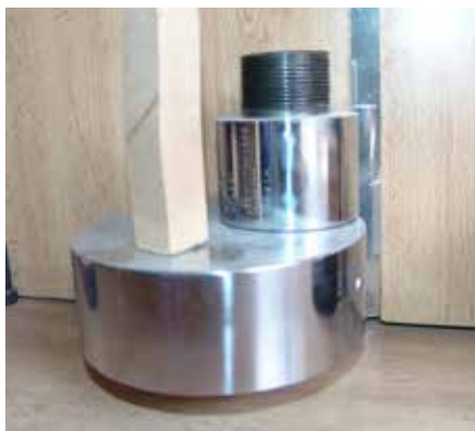
شکل ۳- نمونه‌ها و فک‌های آزمایش فشار موازی و عمود بر الیاف
