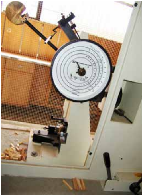
شکل ۹- دستگاه آزمایش مقاومت به ضربه
