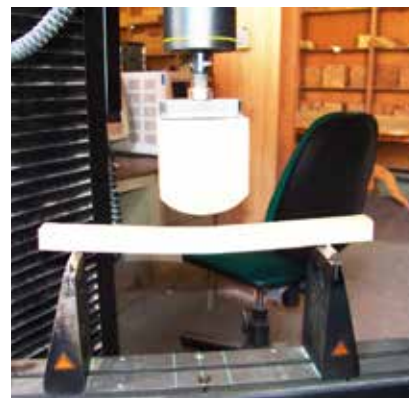
شکل ۲- نمونه و فک آزمایش خمش استاتیک
