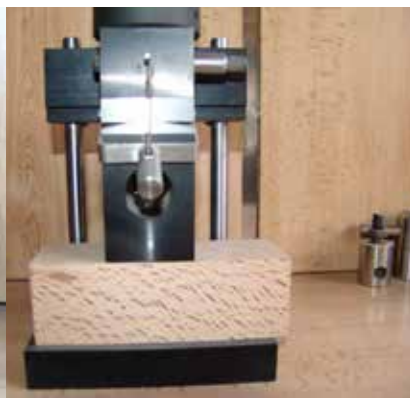
شکل ۳- نمونه‌ها و فک‌های آزمایش فشار موازی و عمود بر الیاف
