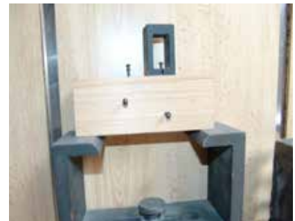
شکل ۵- نمونه مقاومت به خروج میخ
