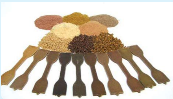
شکل ۵- کامپوزیت‌های چوب-پلاستیک و موارد کاربرد آن در صنایع مختلف دریایی و ساختمانی
