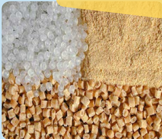
شکل ۱- استفاده از گرانول‌های ترکیب‌شده چوب و پلاستیک در ساخت کامپوزیت‌ها
